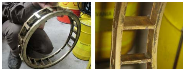
شکل ۵) قفسه معیوب یاتاقان غلتشی
