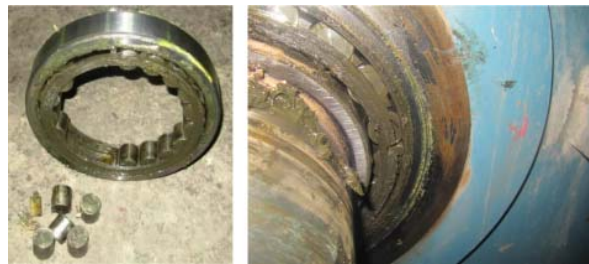
شکل ۴) یاتاقان غلتشی معیوب
