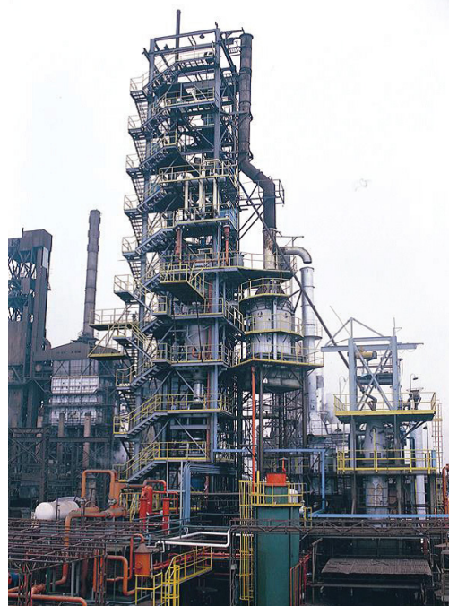
شکل ۵. کمپین های آزمایشی های کارخانه نیمه صنعتی HYL با (حجم) H_2 \geq 90\% .
