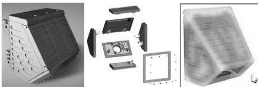
شکل ۷. قطعات مونتاژ شده بلوک برآمده و مدلسازی CFD.
