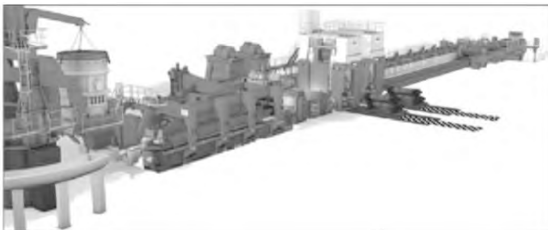
شکل ۶. طرح سه بعدی مفهوم میکرومیل: ریخته‌گری BCT و نورد درون خطی.
