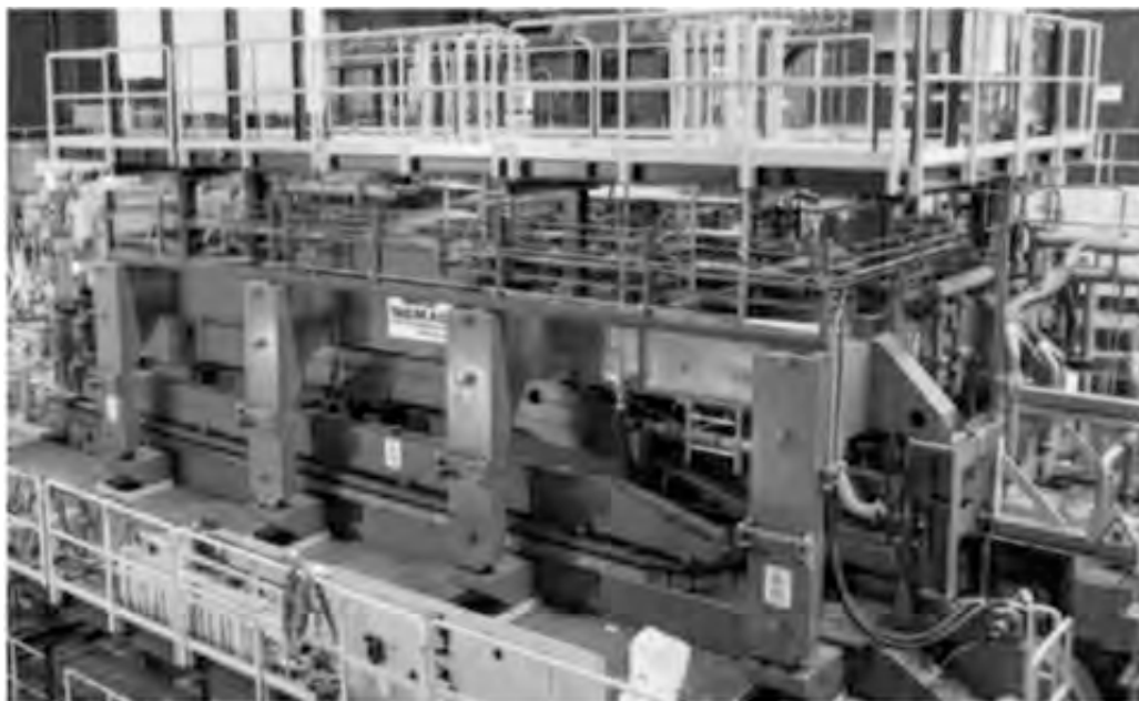
شکل ۲. تجهیزات ماشین ریخته‌گری BCT در کارخانه Peine.
