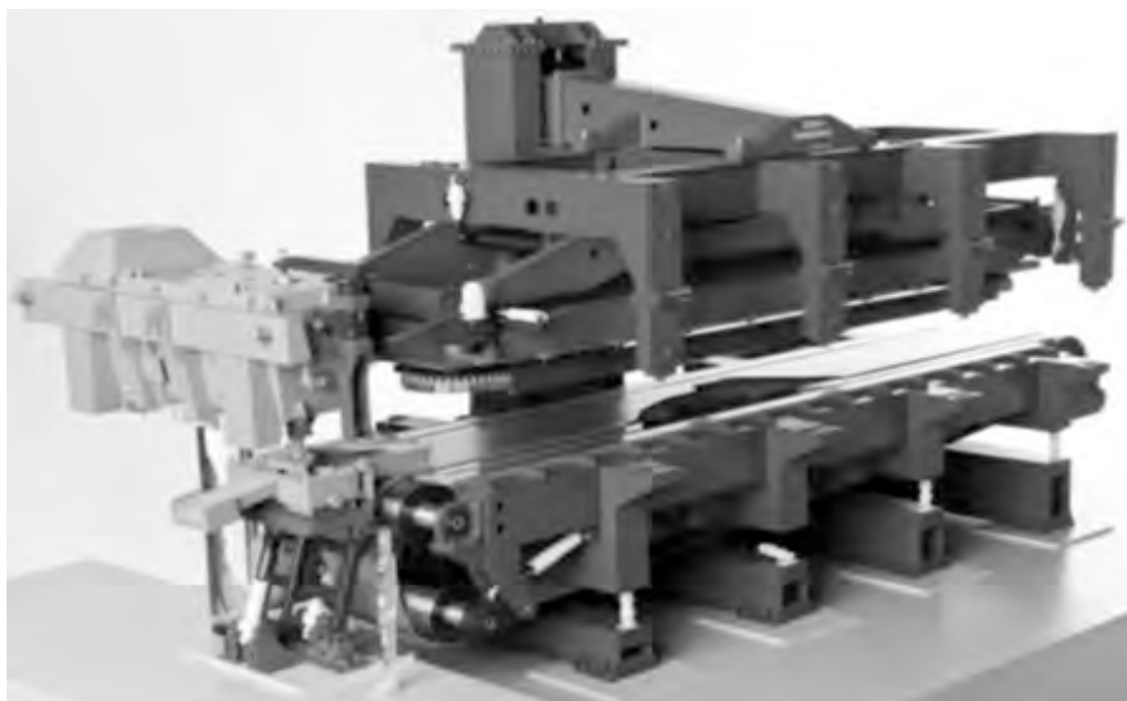
شکل ۳. تاندیش، سیستم تغذیه و ماشین ریخته‌گری BCT با قاب بالا رفته بالائی.
