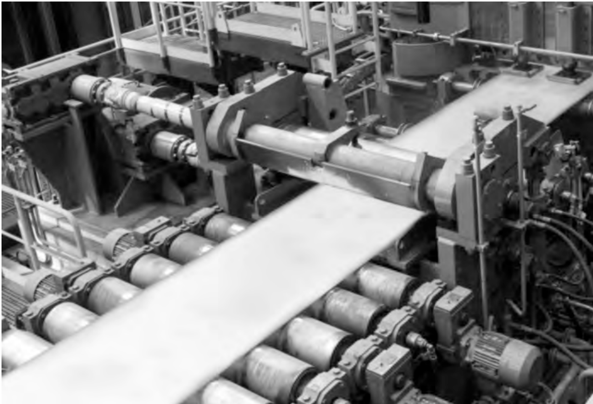
شکل ۴. نوار ریخته‌گری شده در غلتک کشاننده (پینچ رول) و قیچی.
