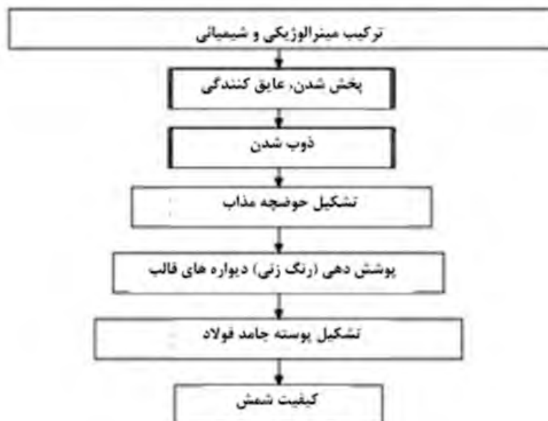
شکل ۴. طرح شماتیک از مراحل عملکرد پودر قالب
