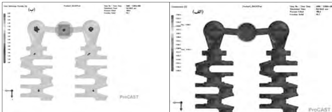
شکل ۲. نتایج شبیه سازی قطعه بدون حضور پلیسه مبردی، الف) زمان انجماد منطقه گرم قطعه حدود ۹۴۰ ثانیه است، ب) درصد پیش بینی انقباض توسط نرم افزار شبیه سازی
