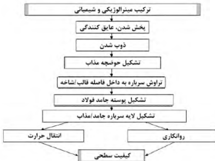
شکل ۸. ارائه شماتیک مراحل عملکرد پودر قالب
