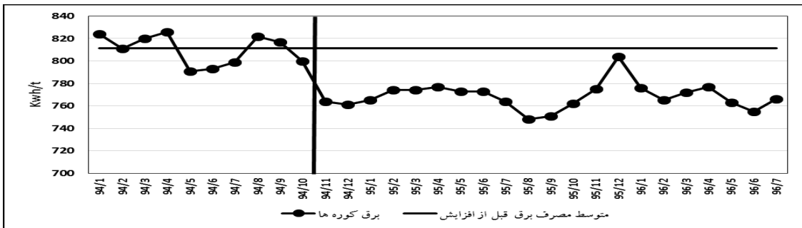
شکل ۳. کاهش مصرف برق کوره‌ها نسبت به متوسط قبل از افزایش درصد کربن
