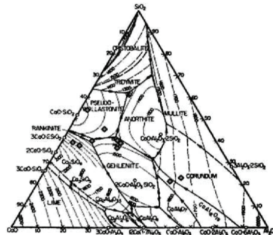
شکل ۲. ترکیب شیمیائی در ذوب شماره ۱۴۸۸۰ کارخانه Sidenor (مسیر EAF ورخته‌گری بیلت)
