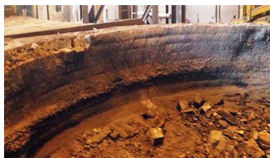
شکل ۱. خوردگی گسترده در خط سرباره ناشی از: (۱) انحلال مواد \text{MgO} در سرباره و (۲) بار حرارتی بالا توسط تابش قوس الکتریکی.
