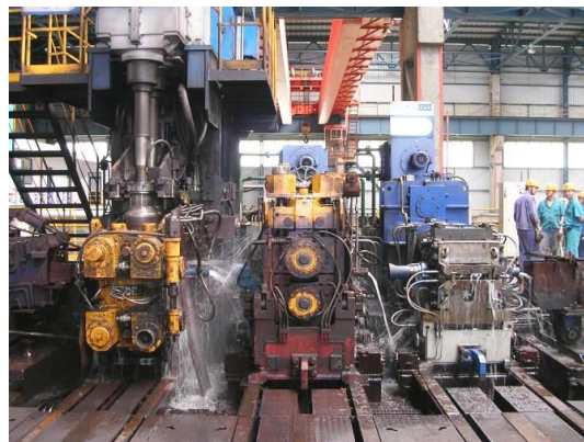
شکل ۱. خط نورد اندازه کننده دقیق ۲-غلتکی و PRS.
