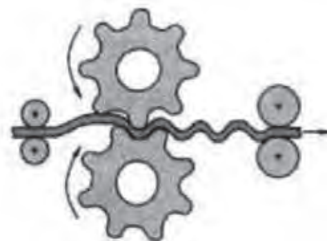
شکل ۱۰. شماتیک روش RCS در تولید فلزات ریزدانه.
