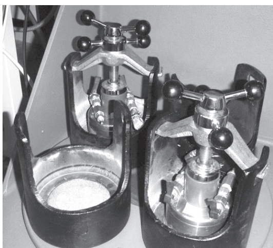
شکل ۵. استفاده از آسیاب گلوله‌ای برای تولید پودرهای نانو ساختار [۴].
