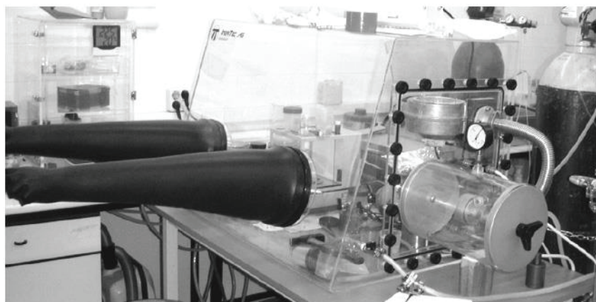
شکل ۶. انجام آلیاژسازی و فعالسازی مکانیکی در اتمسفر خنثی به منظور جلوگیری از ورود آلودگی‌های محیط اطراف به اتمسفر انجام فرایند [۱].
