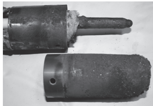
شکل ۳. لوله محافظ پس از یک سیکل کاری کوره.
