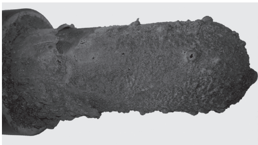
شکل ۸. جزئیات لوله محافظ SiC بعد از ۵ ساعت اندازه‌گیری داخل کوره.
