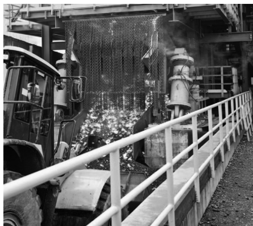
شکل ۱۱. گرانوله کردن سرباره کوره بلند به روش خشک در کوره بلند شماره ۴ دیلینگن آلمان.
