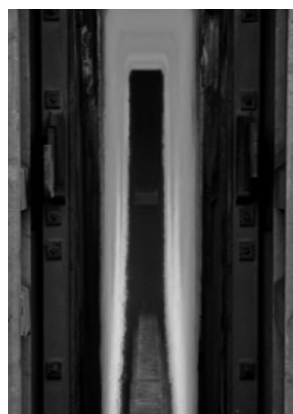
شکل ۴. نمایی از سلول کک سازی تخلیه باطری های اندونزی
