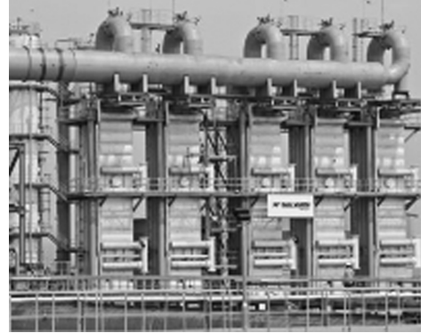
شکل ۵. نمای کلی از خنک کننده های اولیه غیر مستقیم تصفیه گاز باطری کک سازی اندونزی
