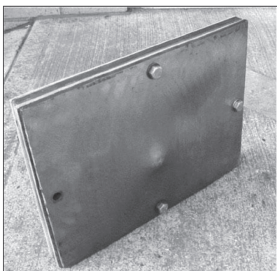
شکل ۹. نتیجه آزمون های بالستیک بر روی فولاد \text{Fe-0.98C-1.46Si-1.89Mn-0.26Mo-1.26Cr-0.09V} استحال شده در 200^\circ \text{C} برای ۵ روز؛ منظر پشت، نشان دهنده عدم نفوذ (با اقتباس و تشکر از P. Brown و D. Crowther)
