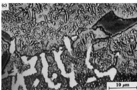
شکل ۶. تصاویر تهیه شده از فولاد مفروض تحت شرایط پیرسازی به مدت ۶ هفته در دمای ۷۵۰°C (a) میکروسکوپ نوری (b) میکروسکوپ SEM با الکترون‌های ثانویه (c) میکروسکوپ SEM با الکترون‌های برگشتی.
