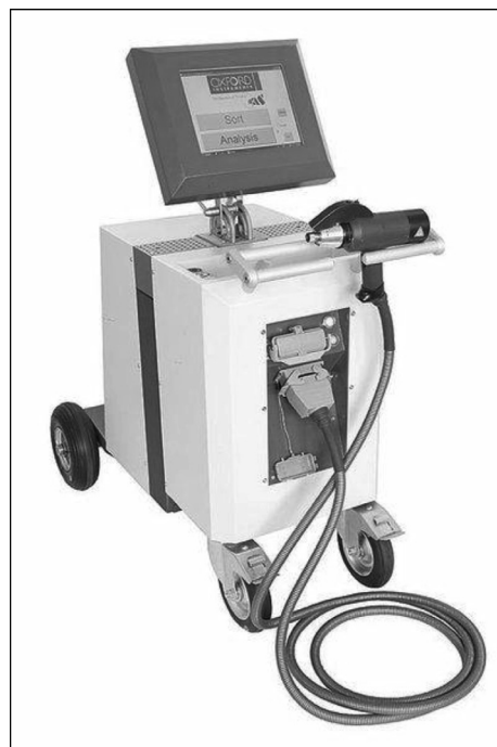
تصویر دستگاه طیف سنج OES قابل حمل
