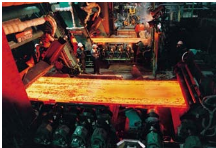
شکل ۳. اسار آلگوما روش تختال نازک را برای تولید گریدهای پریتکتیک برگزیده است.
