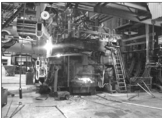
شکل ۳. کوره قوس الکتریکی جریان متناوب ۸ تنی MEFOS.
