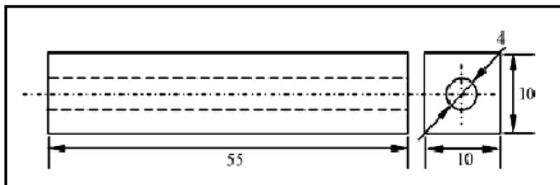
شکل ۱. تصویر شماتیکی از نمونه آزمون چقرمگی ضربه چارپی (همه ابعاد به میلیمتر است).
