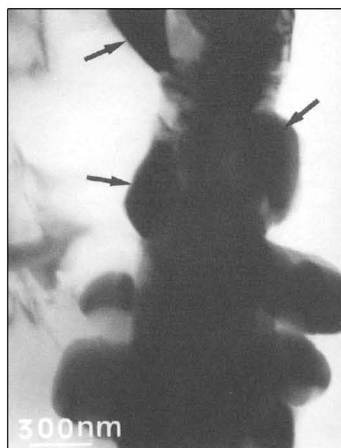
شکل ۶. رسوبات فاز G در فصل مشترک کاربید کرم/زمینه در آلیاژ B بعد از ۱۰۰۰ ساعت پیر سازی در دمای ۷۰۰°C.
