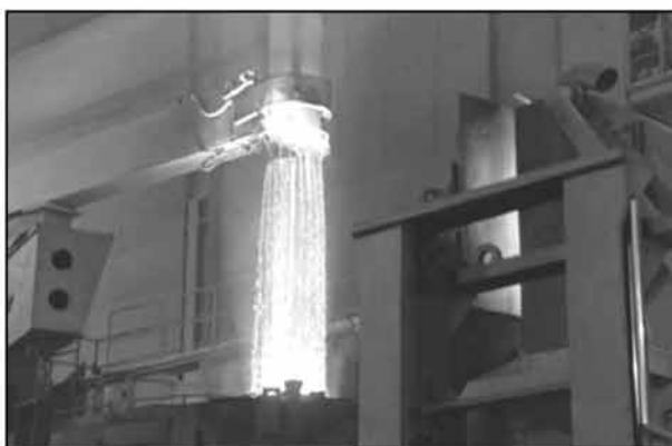
تصویر ۴. موقعیت حلقه پاشش آب خنک کننده الکترودها.
