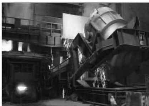
شکل ۴. نحوه شارژ چدن مذاب در کوره قوس الکتریکی ویلینگپ بیسبروک آمریکا.
