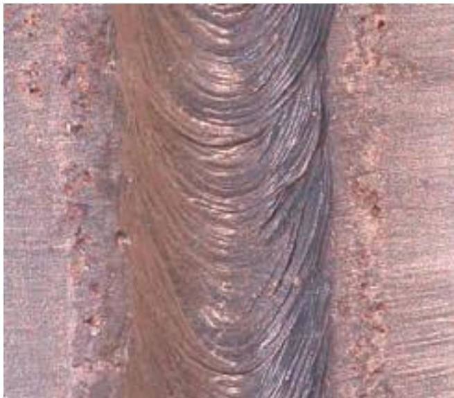
شکل ۲۷-۱: ساق جوش یکنواخت (toe)
