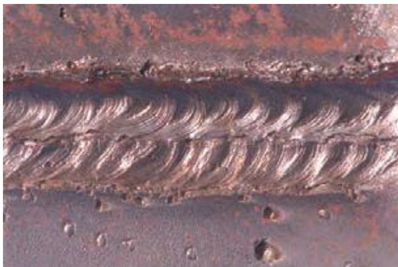
شکل ۴۰-۱: اندازه گرده جوش در پاس پوششی
