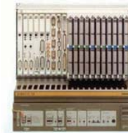
Fig. 22.4 A mini PLC System
