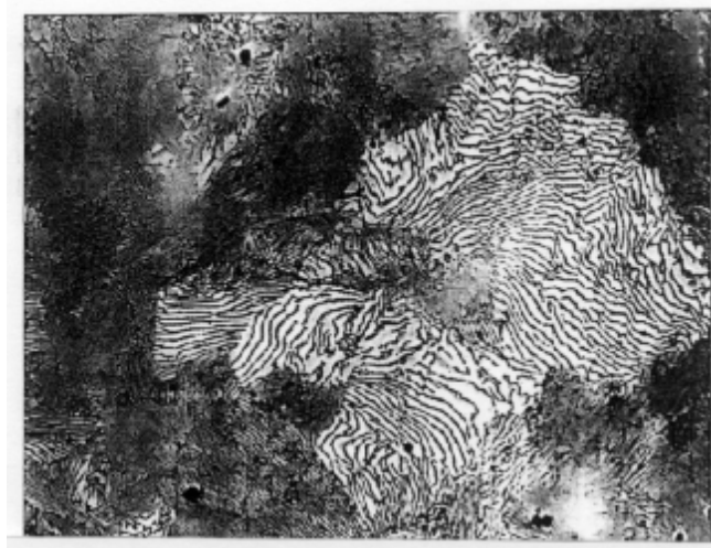
شکل 5 پرلیت در فولاد پر کربن (بزرگنمایی 550 برابر)
