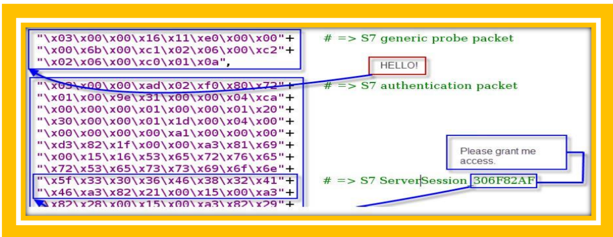
تصویر 4: ضعف امنیتی ذکر شده در Siemens PLC
