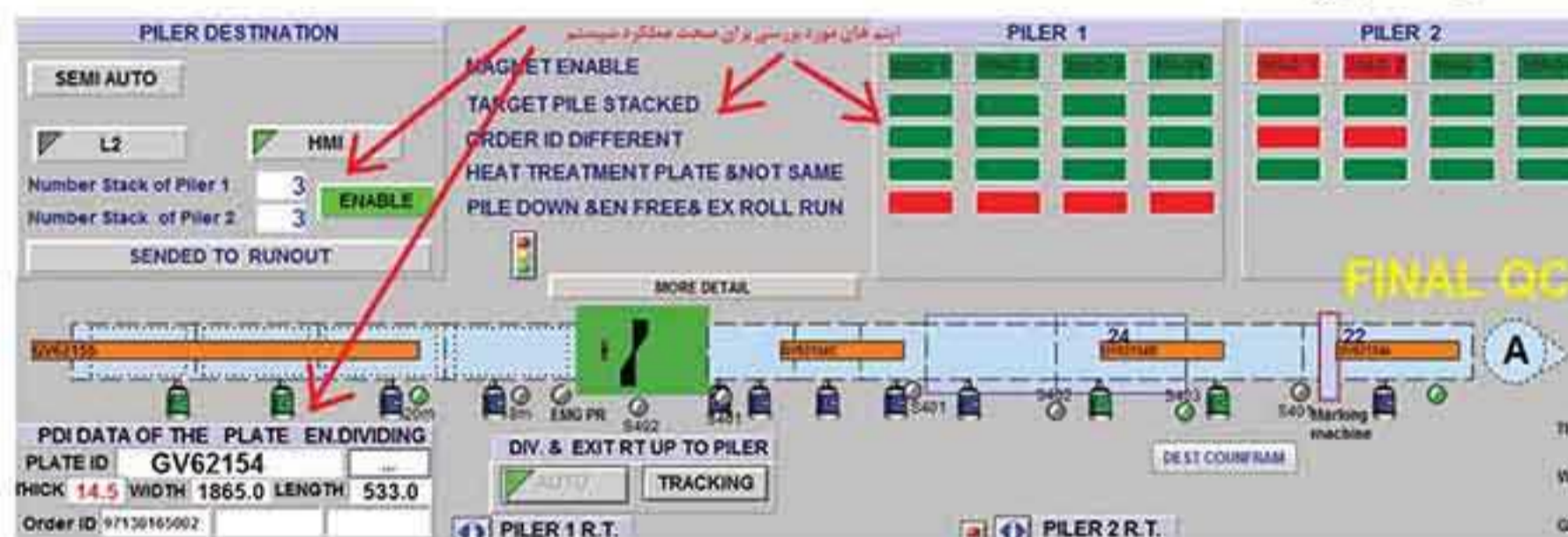
تصویر ۱۰- نحوه هدایت ورق ها به قسمت های مناسب پایلر توسط PLC خط تولید
