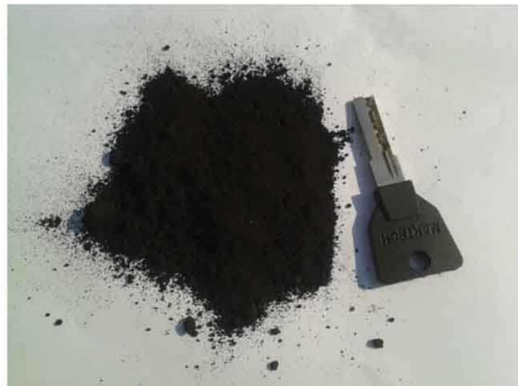
شکل ۱- پوسته های اکسید آهن تولید شده از کوره های پیشگرم و فرایند نورد گرم اسلب های فولادی (با دانه بندی ۳ تا ۳۰ میکرومتر)
