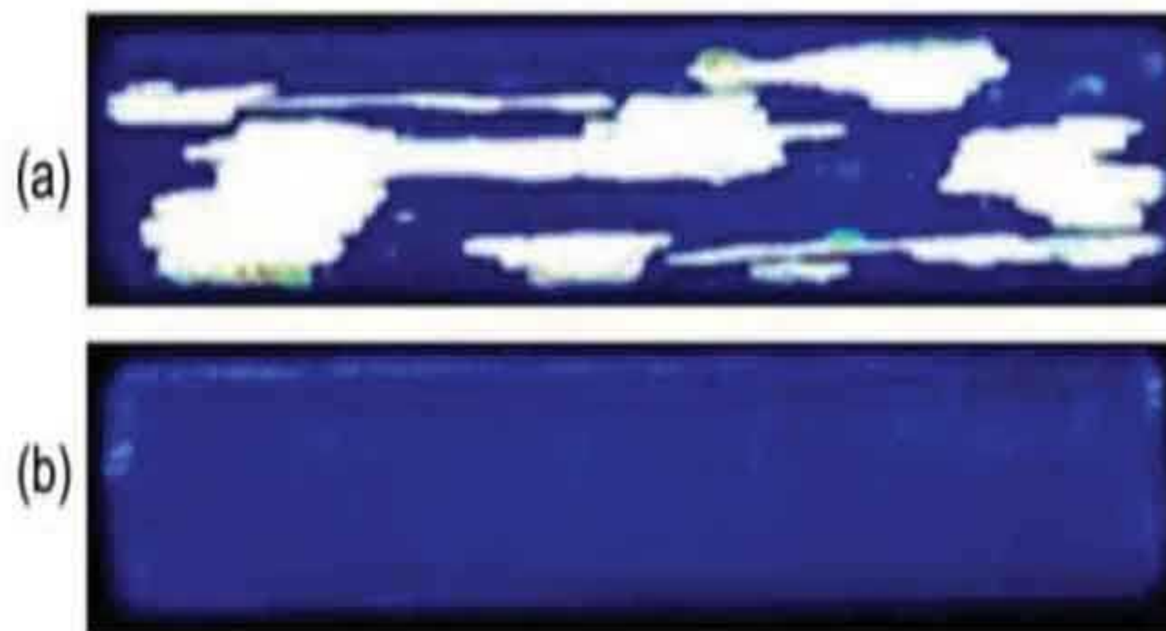
شکل ۳- میزان وقوع HIC اسکن شده توسط دستگاه الکترونیکی؛ (a) فولاد A و (b) فولاد H
