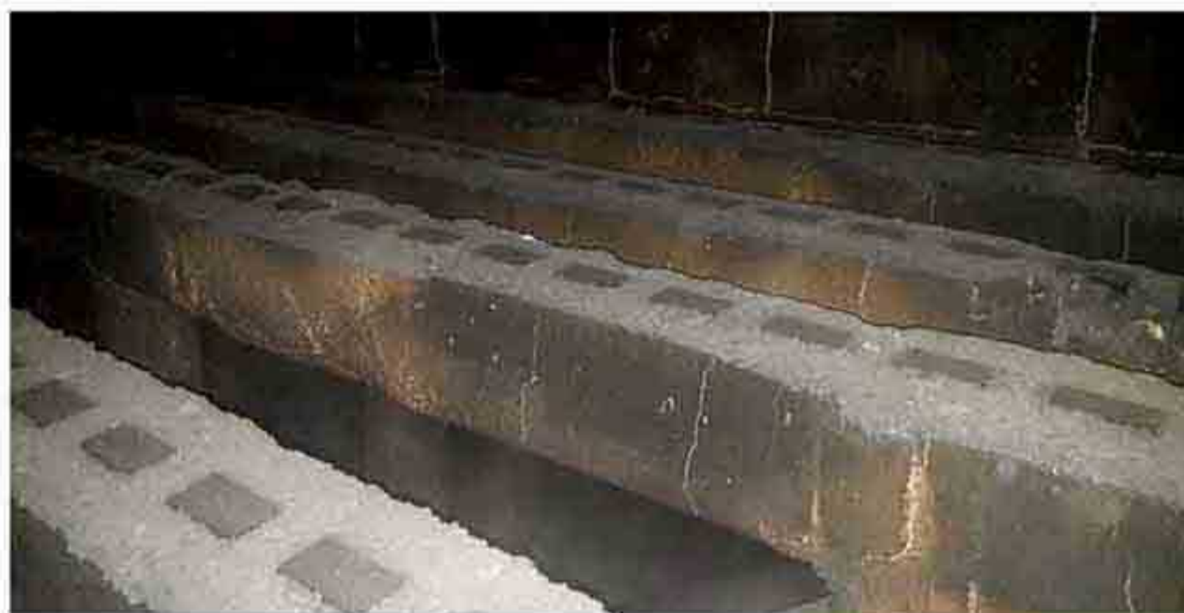
ریزش پوسته های اکسیدی و پر شدن فضای میانی و جانبی skid button ها
