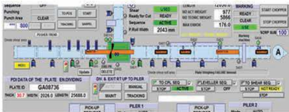
تصویر ۱: قسمتی از سیستم رهگیری محصول خط تولید
