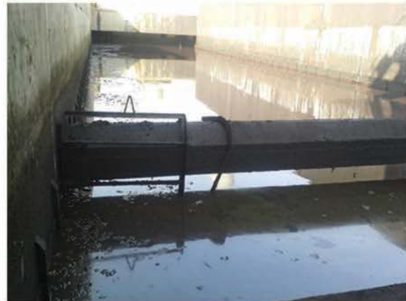
شکل ۱- استخر ته نشینی پوسته های اکسید آهن و جمع آوری روغن های صنعتی
