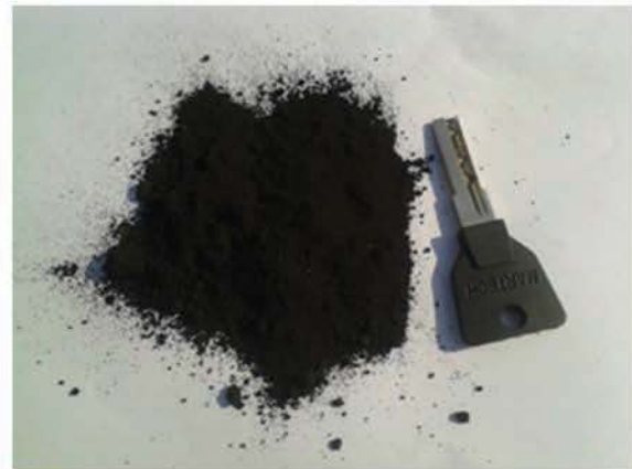
شکل ۴- نرمه های اکسید آهن تولید شده از بخش های کوره های پیشگرم و فرایند نورد که داخل استخر ته نشین می شوند
