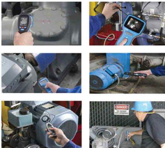
شکل ۳: تجهیزات مراقبت وضعیت
