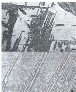
شکل ۸- (a) میکروساختار نوری بینیت بالایی (b) میکروساختار الکترونی بینیت بالایی
