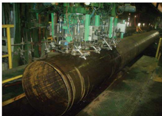
شکل ۵- بازرسی خط جوش لوله تولیدی بوسیله آزمون فراصوتی
