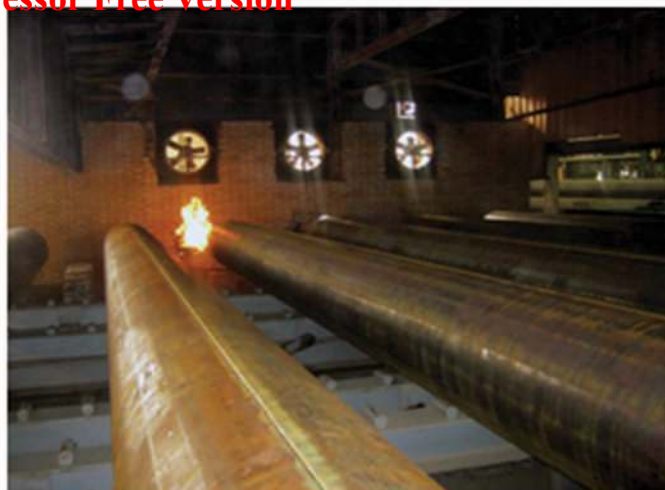
شکل ۴- لوله تولیدی پس از خروج از قسمت ساخت و قبل از عملیات جوشکاری
