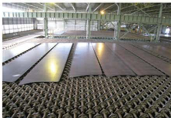
شکل ۱- ورق های تولید شده در حال خنک کاری توسط هوا
