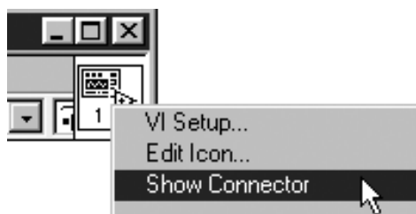
شکل ۳-۳۸: نحوه‌ی انتخاب گزینه‌ی Show Connector از منوی کرکره‌ای مربوط به آیکن در صفحه‌ی پانل برنامه
