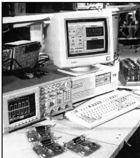
شکل ۳۹-۱۰: برقراری ارتباط بین اسیلوسکوپ و رایانه از طریق کارت GPIB
